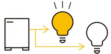
蓄電池システムから家全体に電力を供給する全負荷型と、特定のエリアだけに供給する重要負荷型が選べます。
