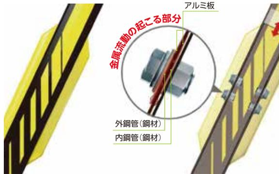
ミューダム®は、刀と鞘のような二重構造の鋼管がスライドする筋交いダンパー。地震が発生すると、スライド部分でアルミと鋼材の金属流動が起こり、地震エネルギーは熱エネルギーに変換され揺れが低減します。
